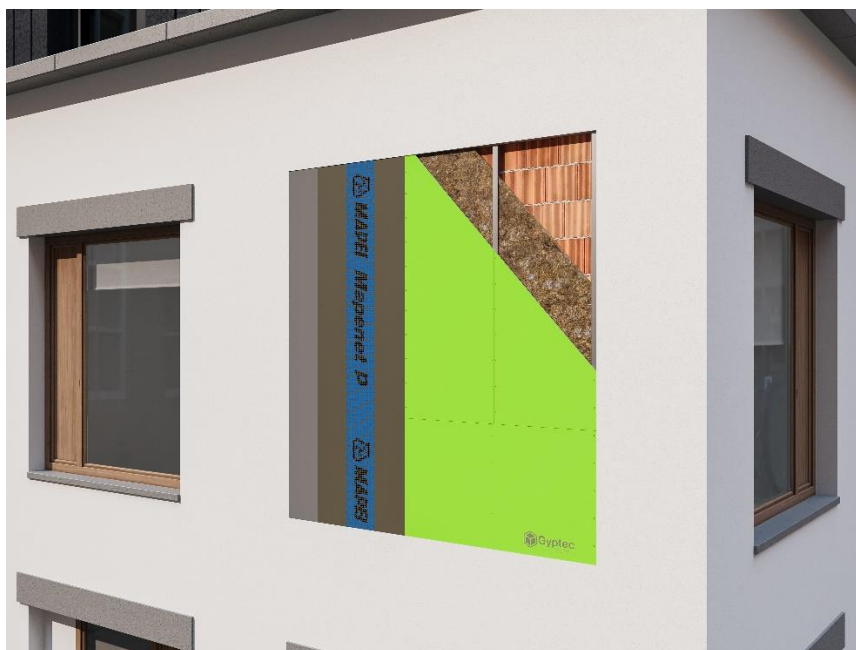
Fig.1 - Solução de Acabamento no exterior com barramento acrílico higienizante.
