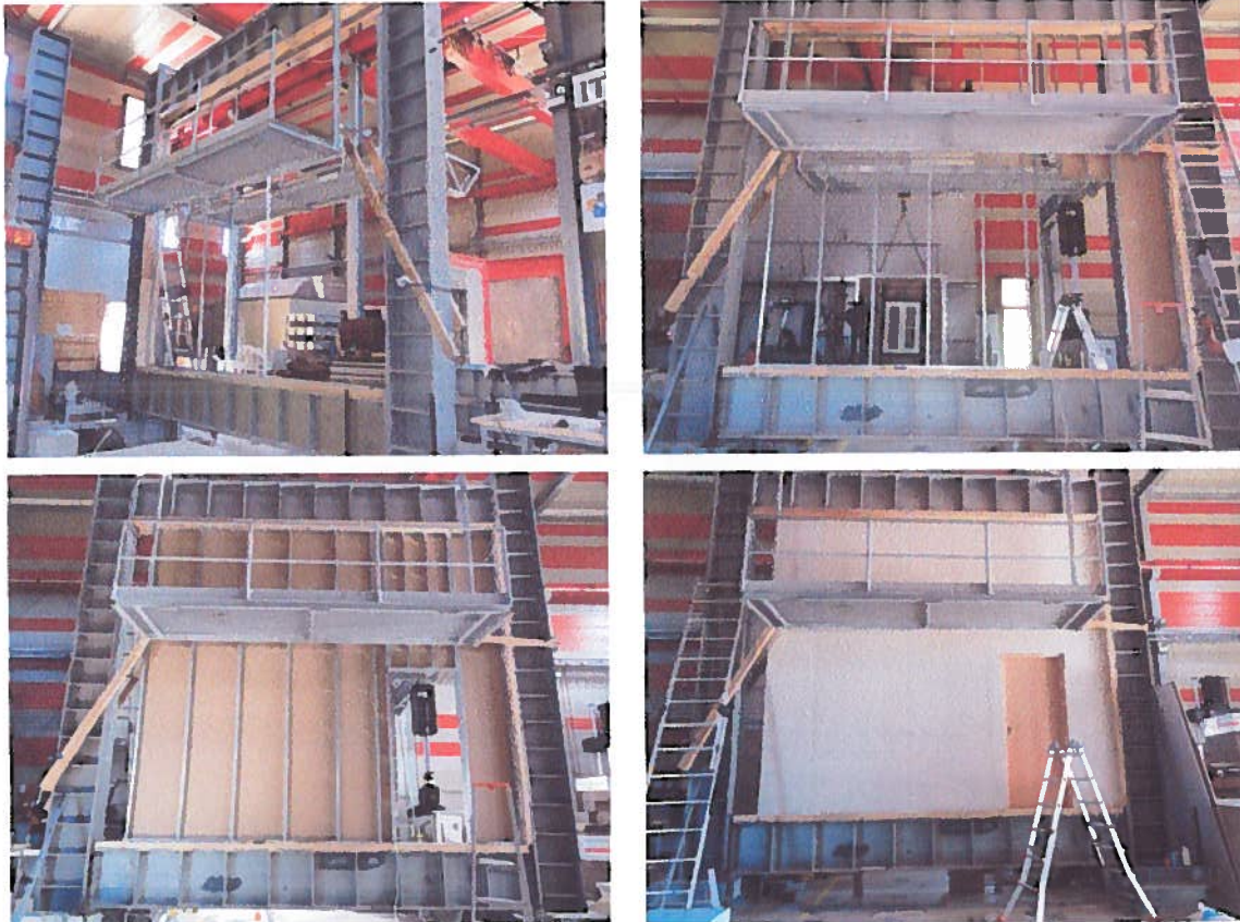
Figura 4: Montagem do provete no pórtico metálico.
